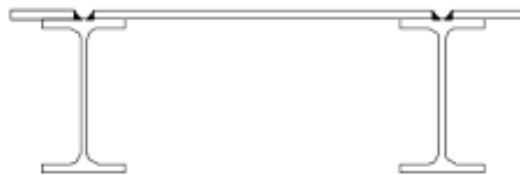
Рис. 5.6. Улаштування плоского металевого настилу по балкам
