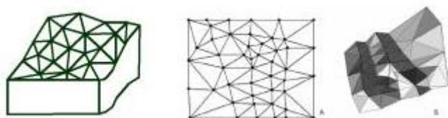
Рис. 1.4. Приклад TIN моделі
