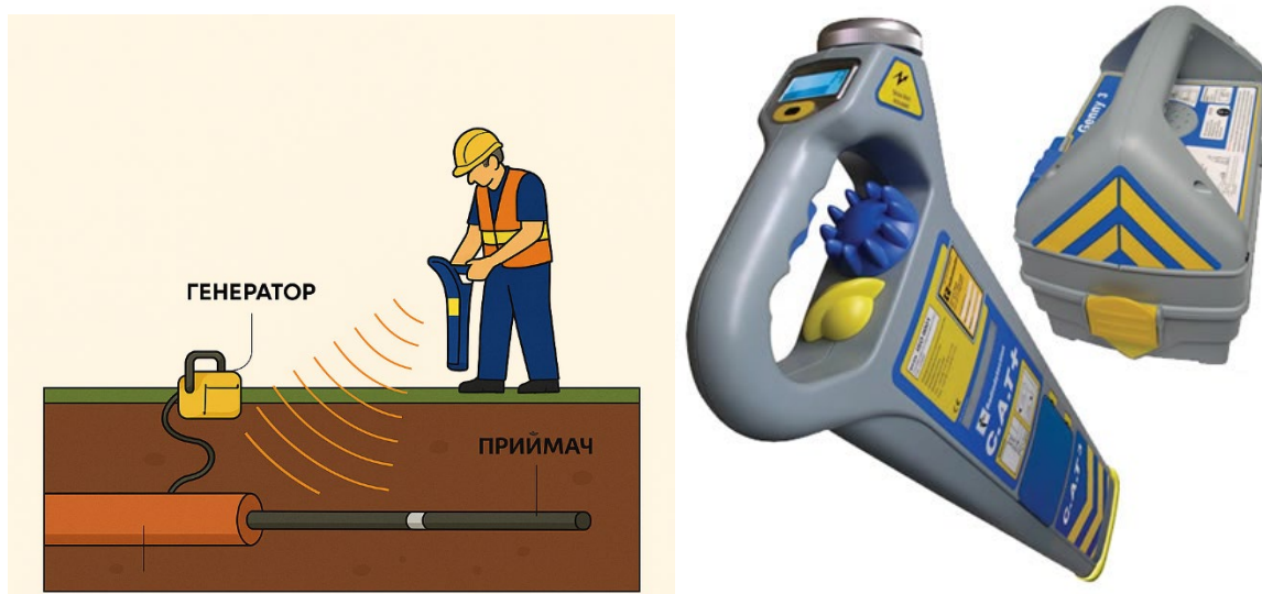
Рис. 1.5.1. Зображення процес виконання методу Електромагнітна локація та трасо шукач С.А.Т+ / Genny+
