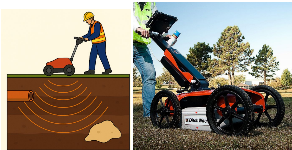
Рис. 1.5.2. Зображення процес виконання методу Георадар (GPR) та Георадару Ditch Witch
