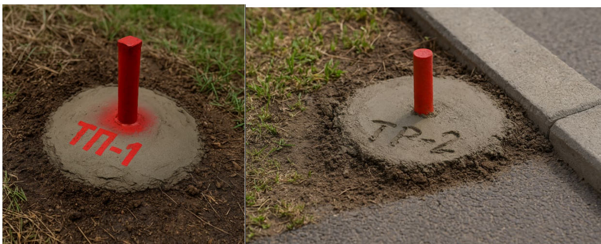
Рис. 1.3.1. Геодезичні репери з відомими координатами у місцевій системі координат МСК-80.
