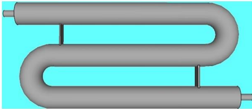
Рис. 6.4. Схема S – подібного реєстра
