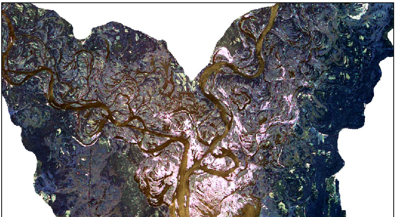
Рис. 4.13 Мультиспектральний космознімок Landsat-8 (B1;B2;B3) після процедури Pansharpening
