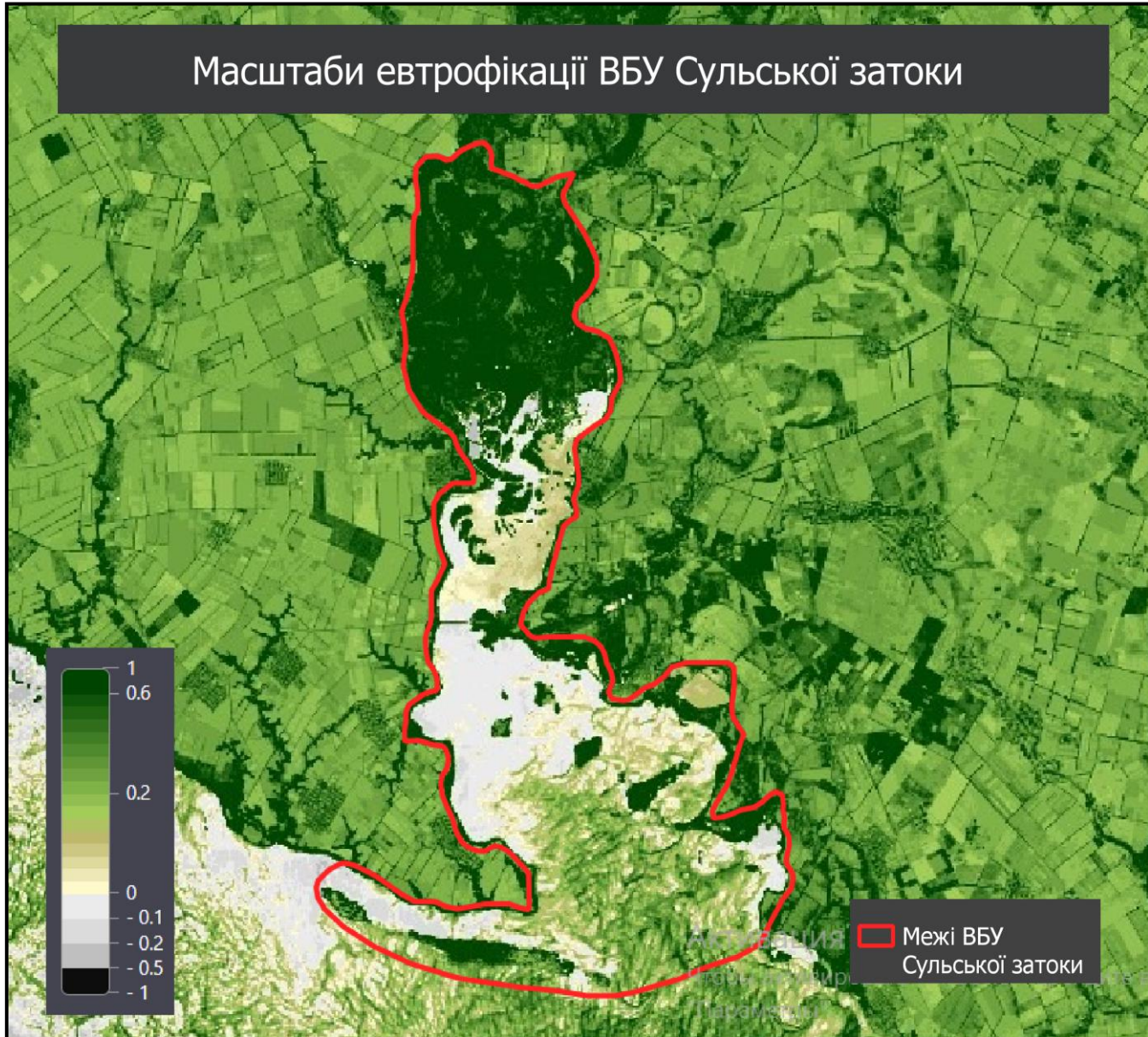
Рис. 4.24 Мультиспектральний космознімок Sentinel-2 L2A з обрахованим індексом NDVI для території ВБУ Сульської затоки Кременчуцького водосховища. Шкала від -1 до 1 показує рівень біомас або активність фотосинтезу: значення ближче до +1 свідчать про високу концентрацію водоростей і сильну евтрофікацію, 0 або нижче 0 можуть вказувати на відкриту воду без значної біологічної активності.
