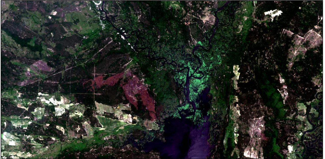
Рис. 4.8. Мультиспектральний космознімок Landsat-8 (B4;B3;B2) після атмосферної корекції
