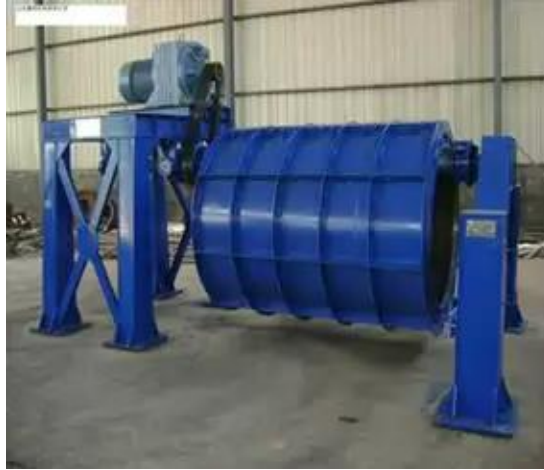
Рис. 1.14. Центробіжно-формувальна установка для виробництва труб і кілець діаметром 300-2500 мм і довжиною 1-4 м
