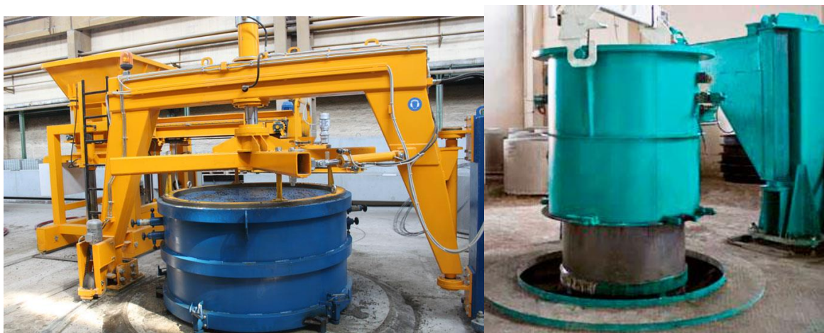
Рис. 1.12. Загальний вигляд установок з вібруючим осердям для формування кілець
