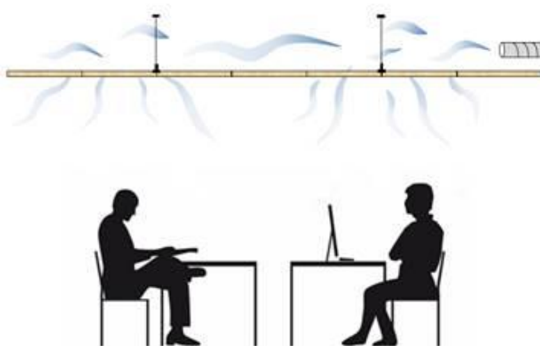
Рис. 1.5. Схема дифузної стельової вентиляції.
