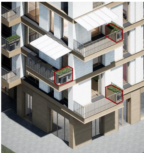
Рис. 7.2.1. Системи кондиціонування на балконах
