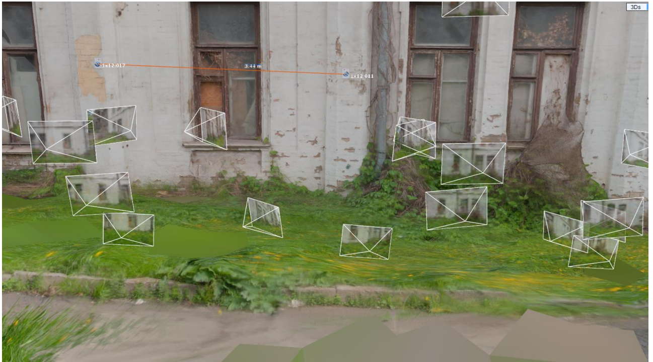
Рис. 3.50. Результат вимірів другої відстані в програмі Reality Capture 1.4 (3,44 м) [Reality Capture 1.4]
