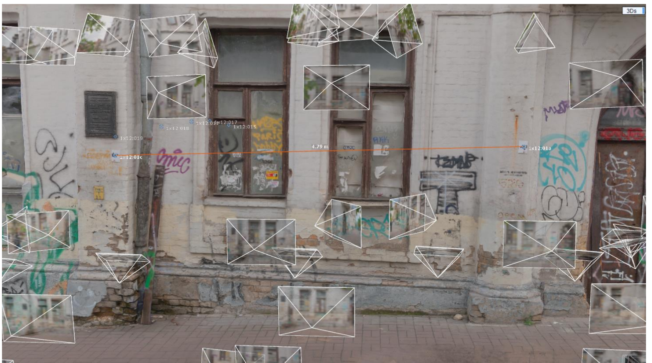
Рис. 3.53. Результат вимірів п'ятої відстані в програмі Reality Capture 1.4 (4,79 м) [Reality Capture 1.4]
