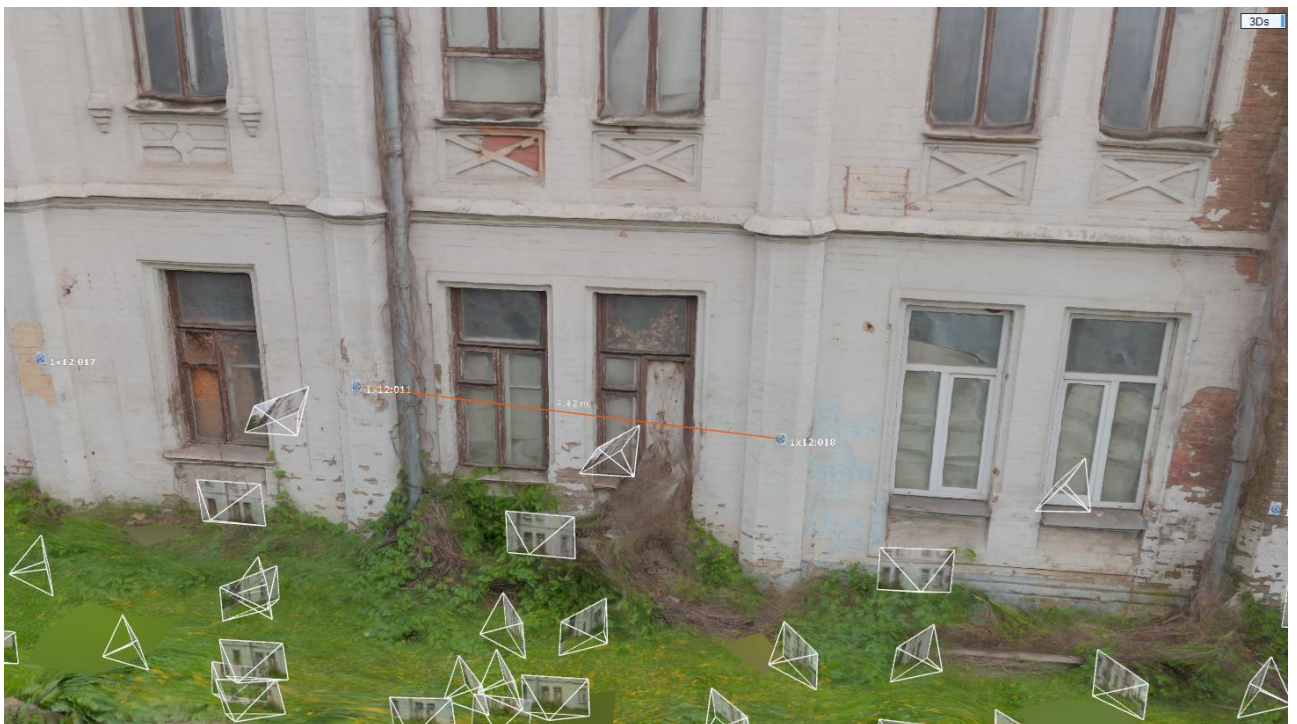
Рис. 3.51. Результат вимірів третьої відстані в програмі Reality Capture 1.4 (4,42 м) [Reality Capture 1.4]
