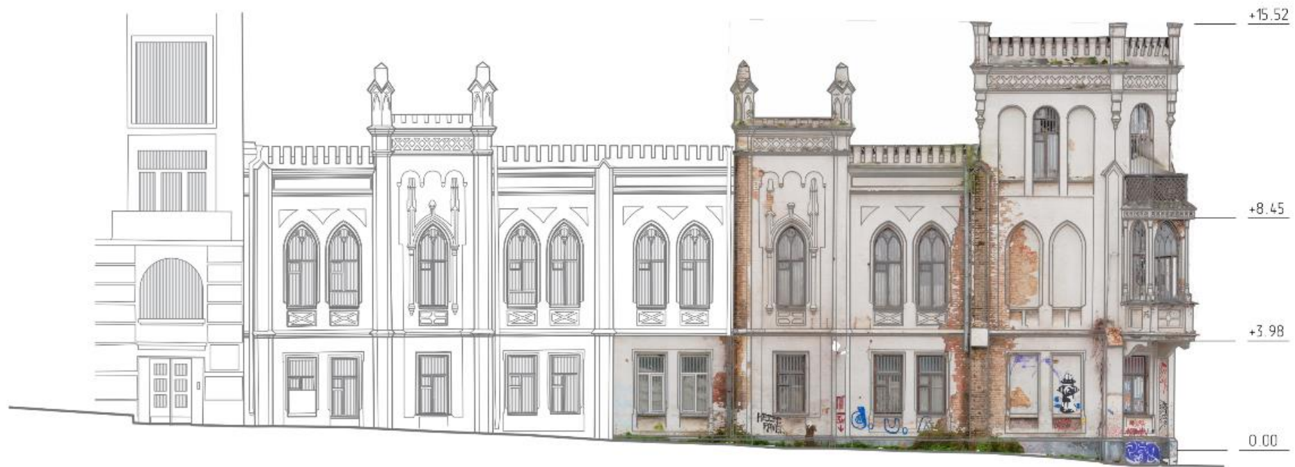
Рис. 3.59. Приклад оформлення креслення споруди за отриманими результатами з програми Reality Capture 1.4
