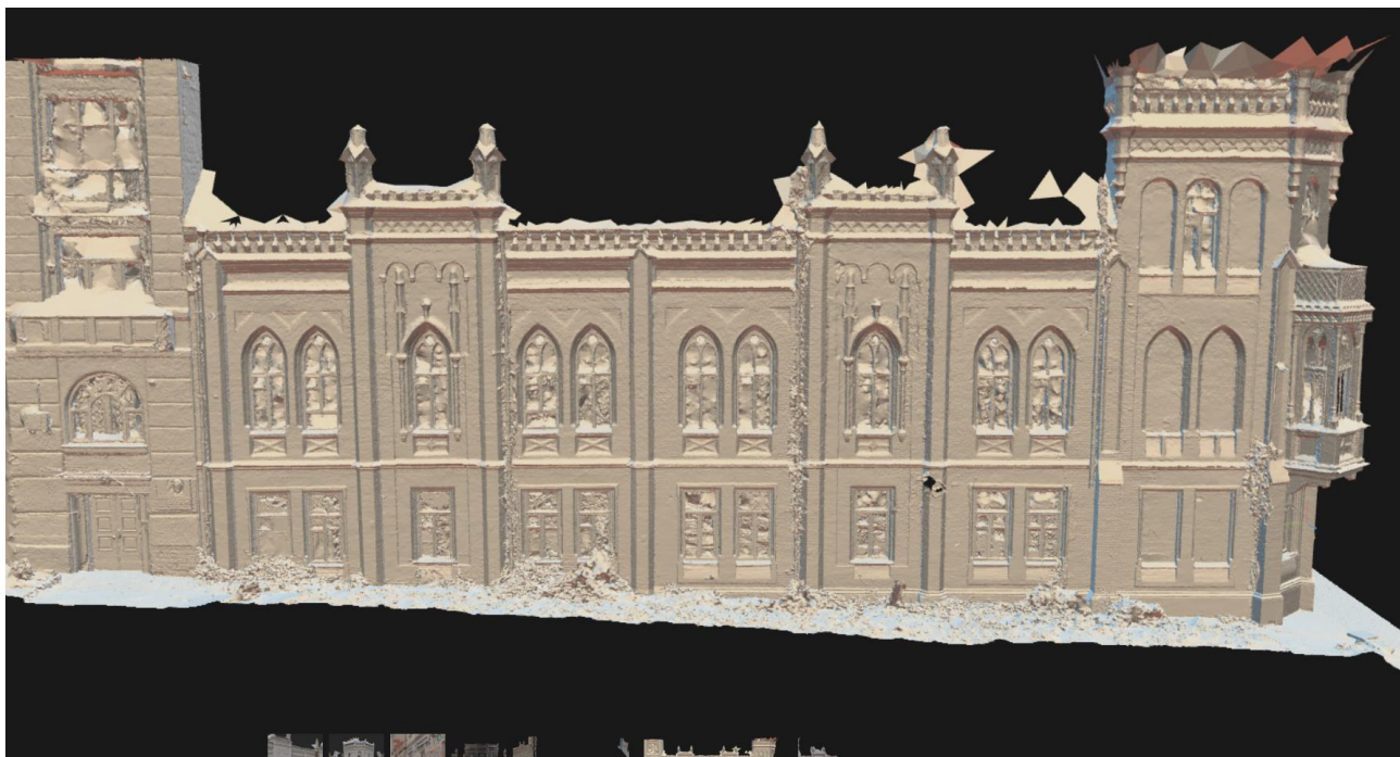
Рис.3.30. Результат згладжування - чистий текстурований Mesh файл [Reality Capture 1.4]
