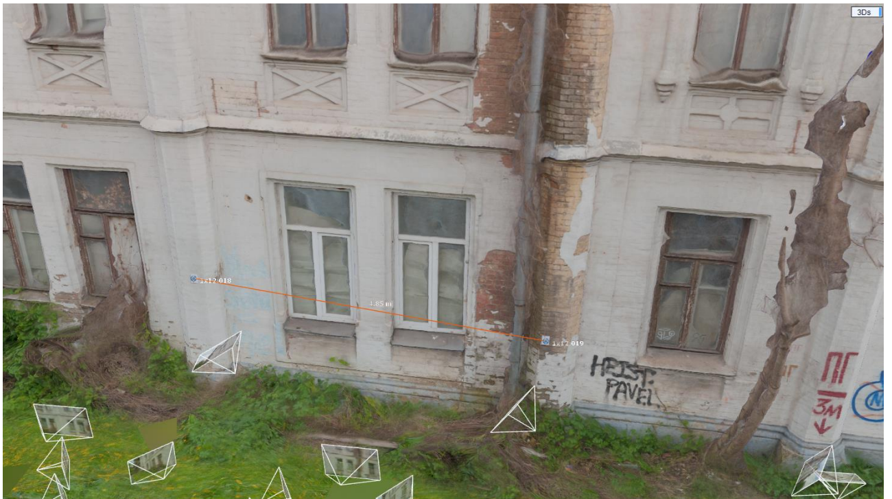
Рис. 3.52. Результат вимірів четвертої відстані в програмі Reality Capture 1.4 (4,85 м) [Reality Capture 1.4]
