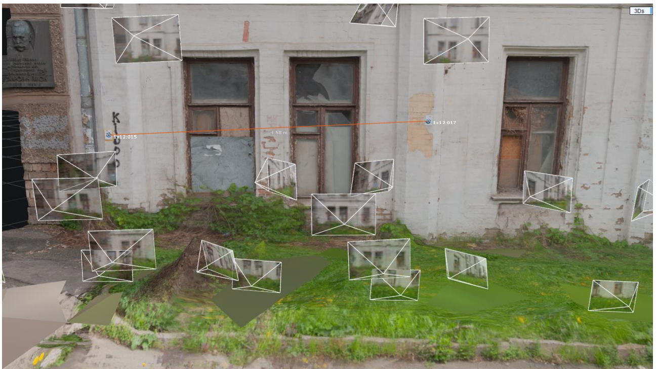
Рис. 3.49. Результат вимірів першої відстані в програмі Reality Capture 1.4 (4,58 м) [Reality Capture 1.4]
