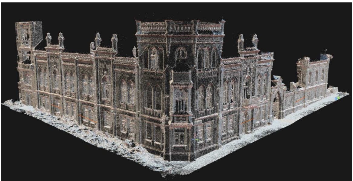
Рис. 3.25. Після вирівнювання, модель представлена у хмарі точок [Reality Capture 1.4]
