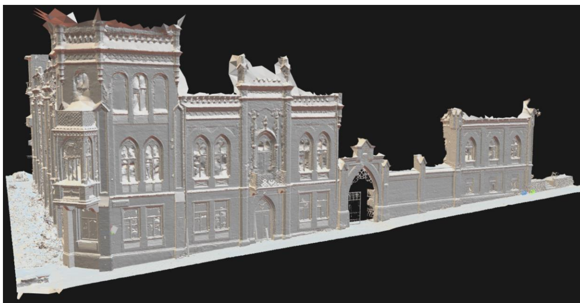
Рис. 3.31. Представлення моделі після поглиблених редагувань [Reality Capture 1.4]
