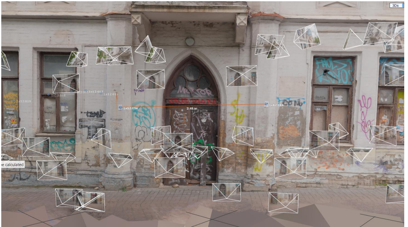
Рис. 3.54. Результат вимірів шостої відстані в програмі Reality Capture 1.4 (3,49 м) [Reality Capture 1.4]
