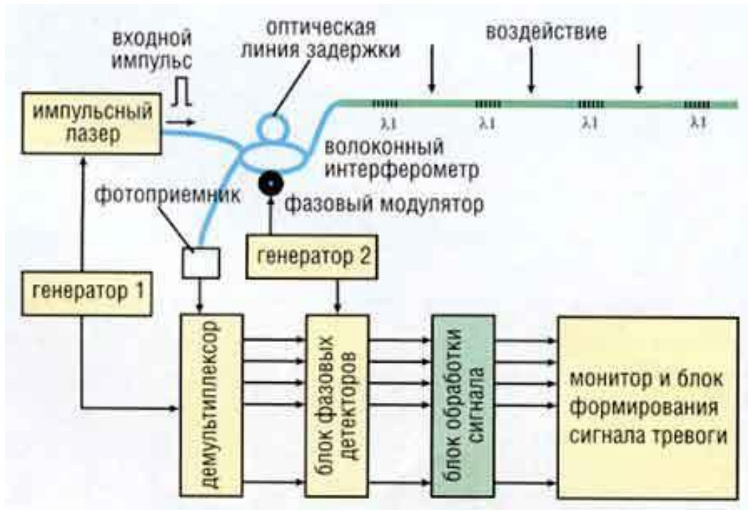
Рис. 1.3 Схема волоконно-оптического розподіленого датчика з решітками на одну довжину хвилі і тимчасовим демультиплексуванням
