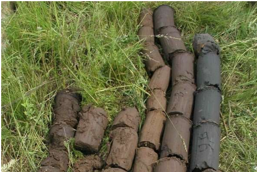
Рис. 27.2. Керни, які утворюються під час колонкового буріння свердловин
