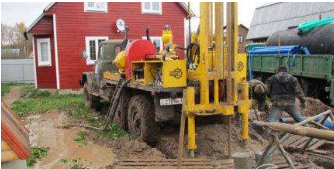
Рис. 28.1. Бурова установка для роторного буріння свердловин
