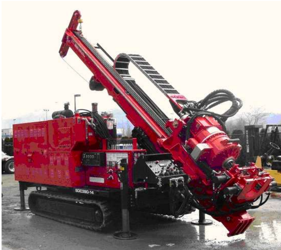
Рис. 29.5. Установка вібраційного буріння
