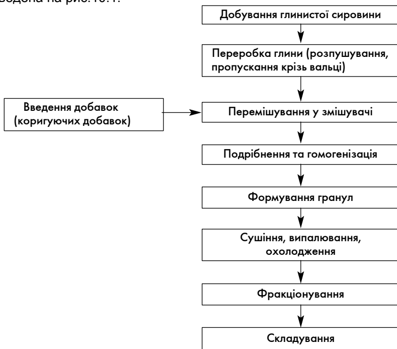
Рис. 10.1. Схема отримання керамзиту пластичним способом
