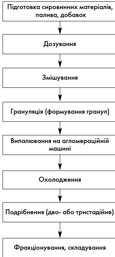
Рис. 10.6. Технологічна схема отримання аглопоритового щебеню та піску
