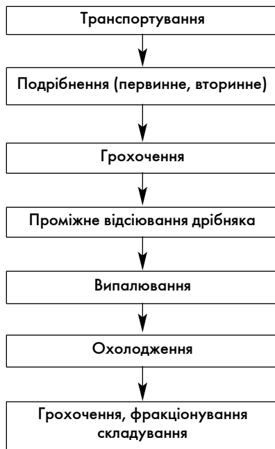
Рис. 10.2. Схема отримання керамзиту сухим способом
