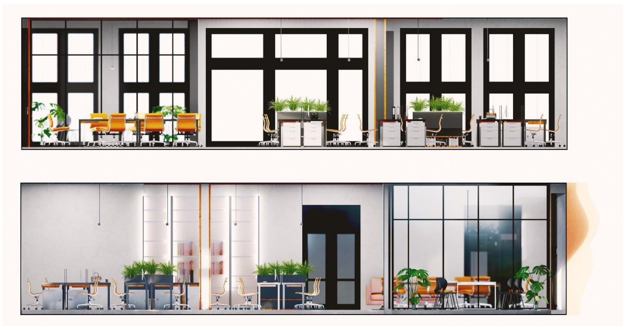
Рис. 5.2. Розгортки приміщення офісу
