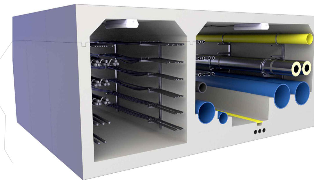
Приклад прокладання підземних комунікацій в колекторі
