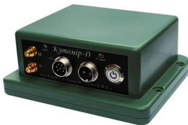
Рис. 4.16. Кутомір-Д: двохантений GNSS приймач для визначення кутової орієнтації
