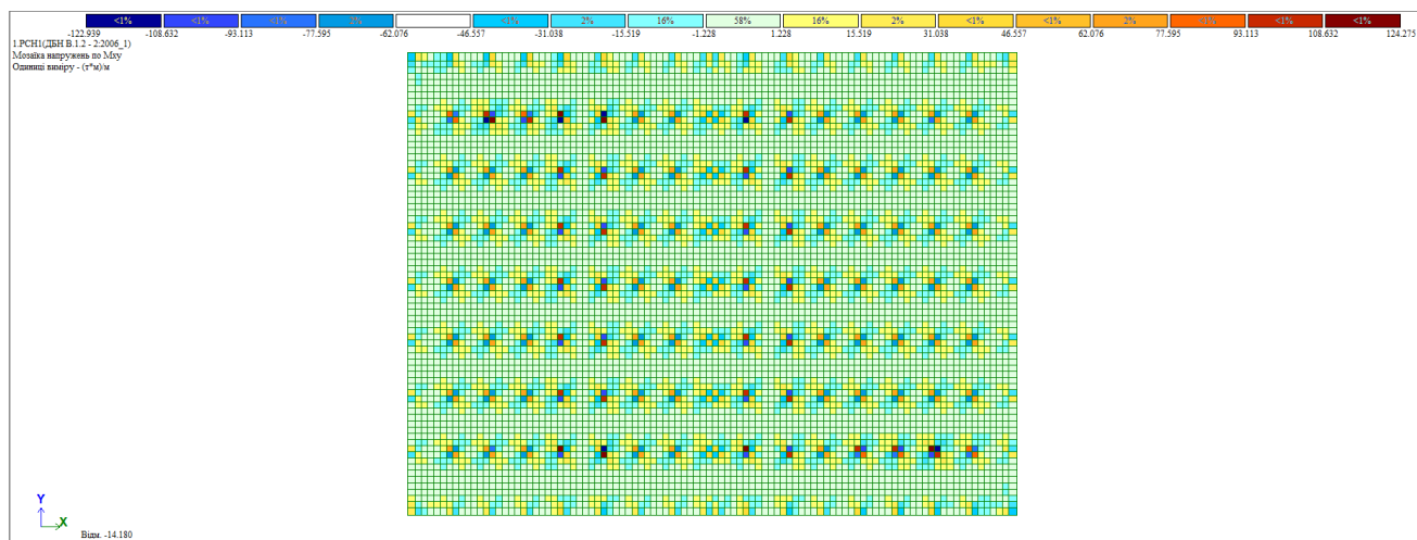
Рис. 3.9 Мозаїка напружень по M_x .
