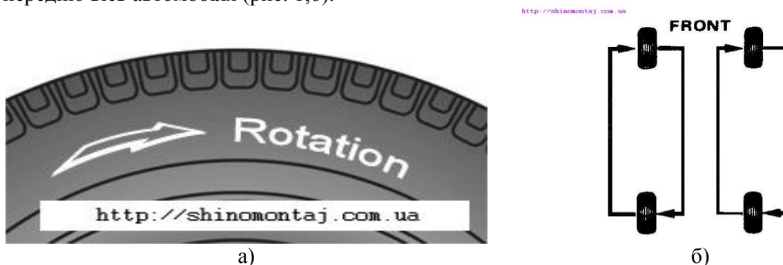
Рисунок 1. Схема перестановки шин із вказаним напрямком обертання:
