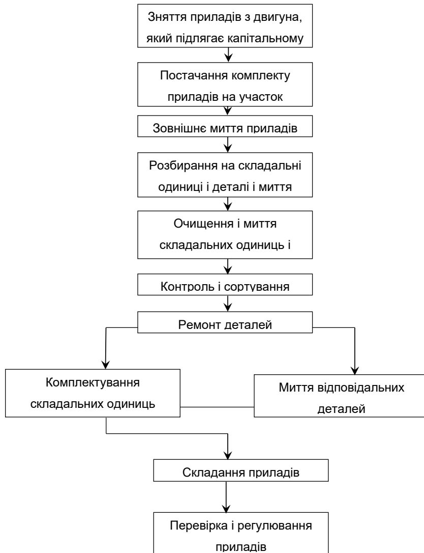
Рисунок 1.5.Схема технологічного процесу ремонту паливної апаратури
