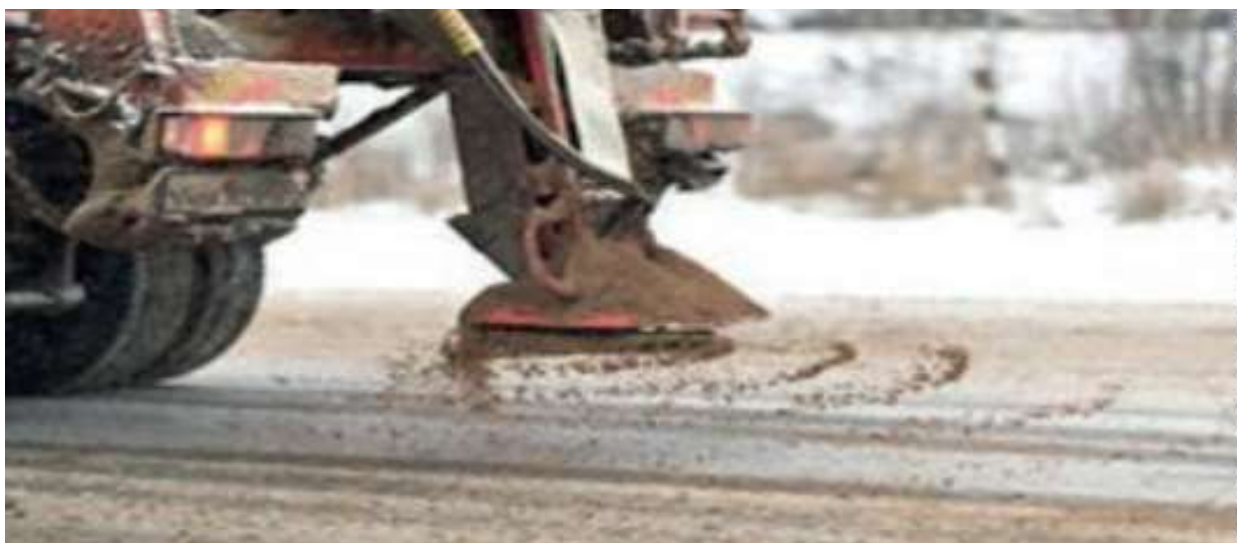
Рисунок 2.1. Фрикційний метод боротьби із зимовою слизькістю на дорогах [1]
