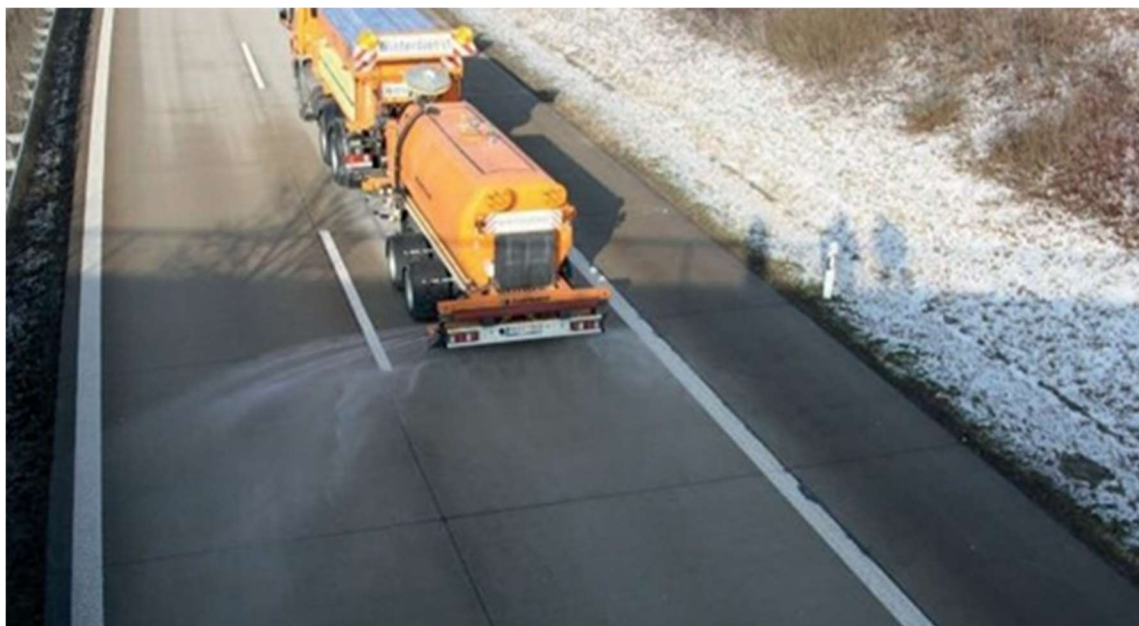
Рисунок 2.2. Метод боротьби із зимовою слизькістю за допомогою хімічного засобу [1]
