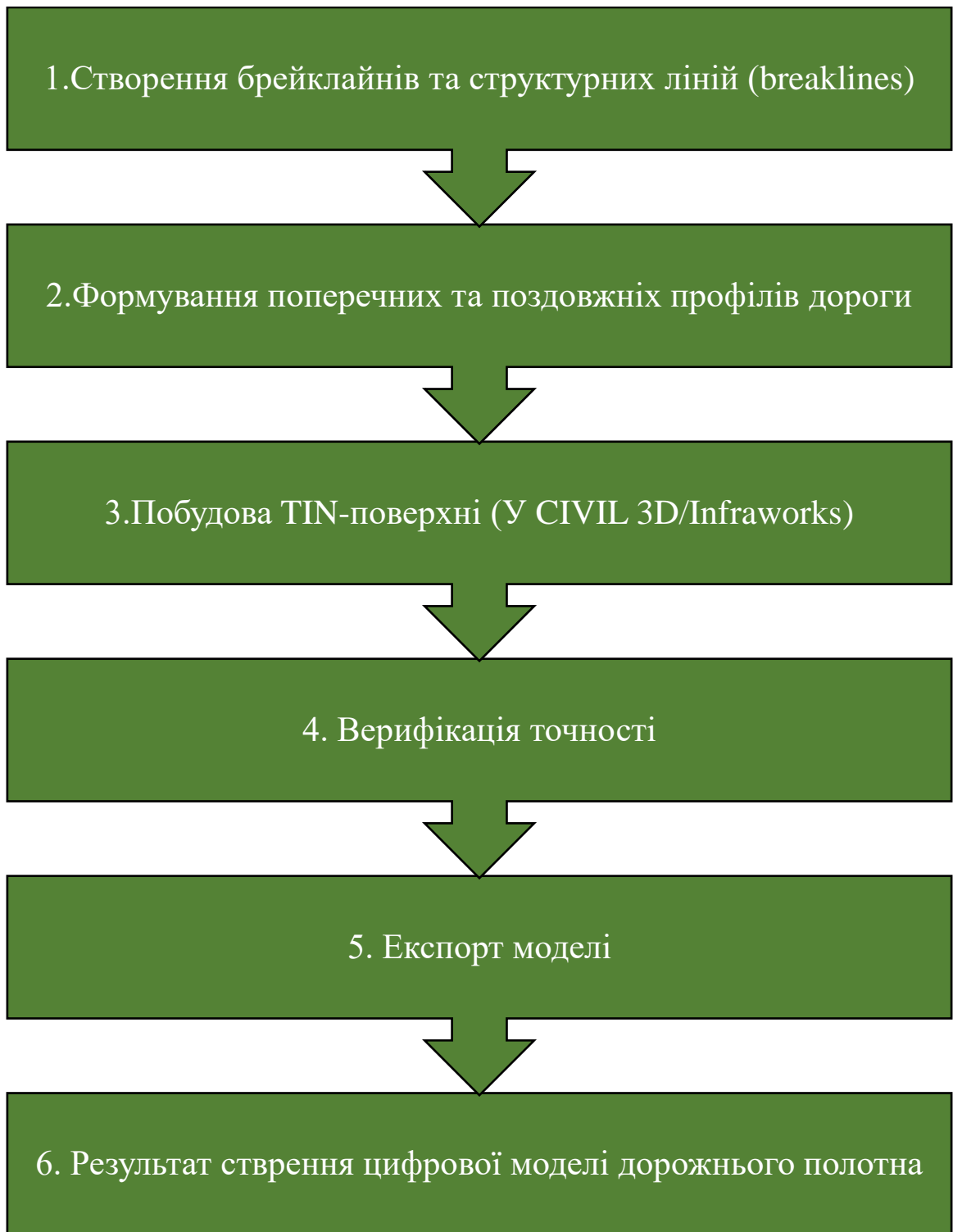
Рис.2.3 «Блок-схема формування базової цифрової моделі дорожнього полотна»
