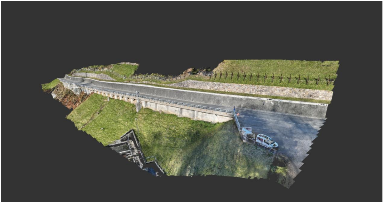
Рис. 1.1.2 «Ілюстрація хмари точок дорожнього полотна як вихідного матеріалу»
