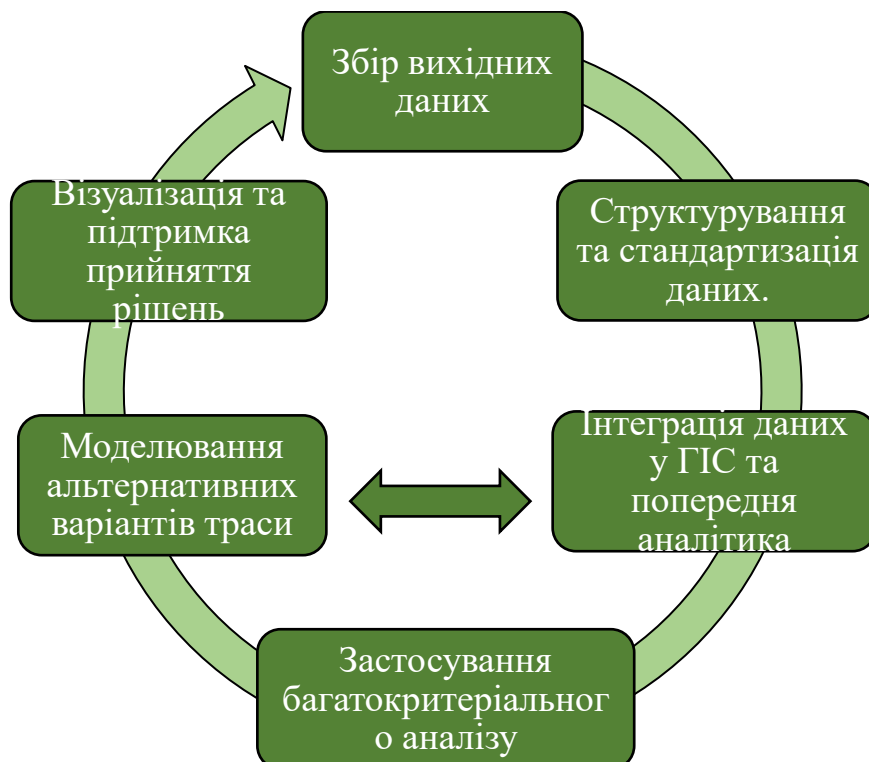
Рис. 1.2.1 «Схема використання геоінформаційних технологій у проєктуванні дорожньої інфраструктури»
