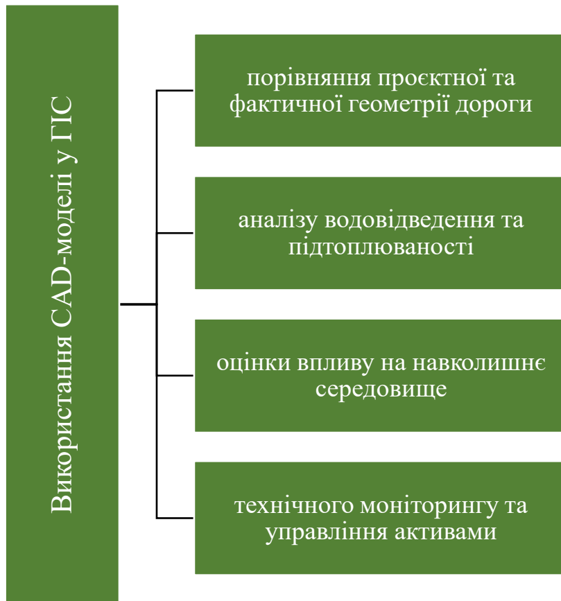
Рис. 3.2 Аналітичне використання CAD-моделі у ГІС
