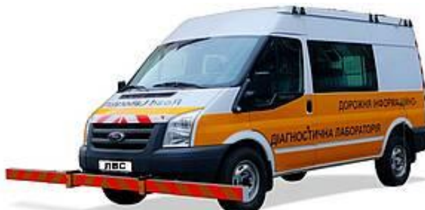
Рис.1.10. Лазерна вимірювальна система (ЛВС-ХНАДУ)
