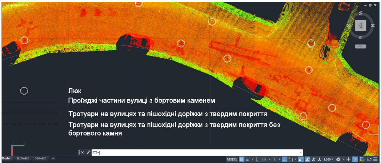
Рис.3.18. Векторизація люків, вид візуалізації хмари точок - інтенсивність
