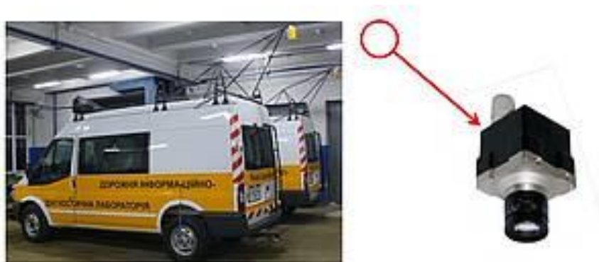
Рис.1.11. Система відеосканування дорожніх покриттів (ОКО-ХНАДУ)
