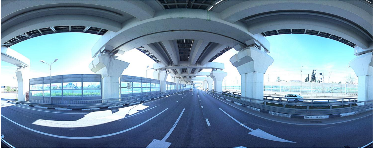
Рис.2.12. Панорамне зображення, отримане під час лазерного мобільного сканування
