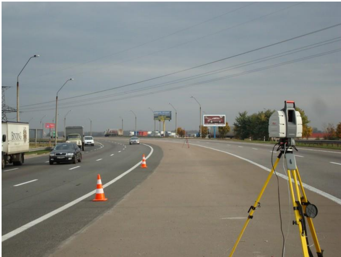
Рис.1.8. Процес виконання зйомки методом лазерного сканування
