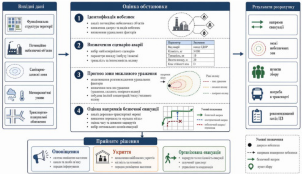
Рис. 5.3.1.1. Узагальнена схема розрахунку заходу цивільного захисту на об'єкті проектування
