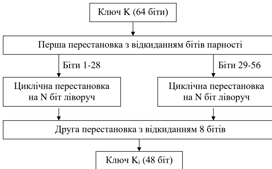
Рис. 3.5. Схема алгоритму перетворень ключа для зашифрування
