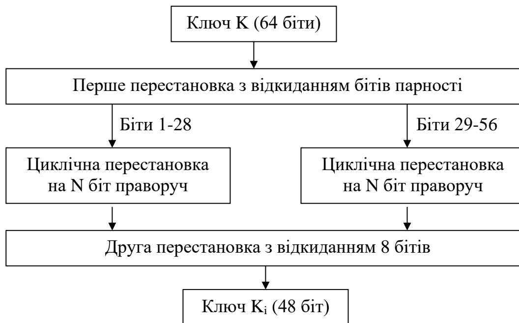
Рис. 3.6. Схема алгоритму перетворень ключа для розшифрування
