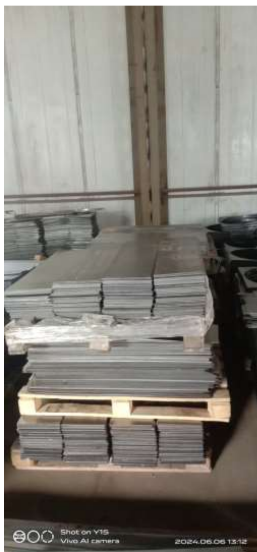
Рис. 2.10. Відрізки металопрокату розмірами 1,5x244x1001 мм, 1,5x135x1764 мм
