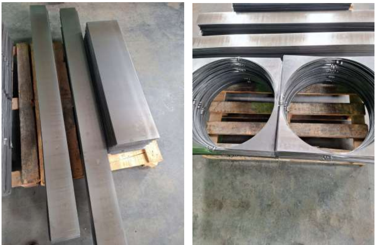
Рис. 2.8. Відходи від вирубки листового прокату при виготовленні бочок
