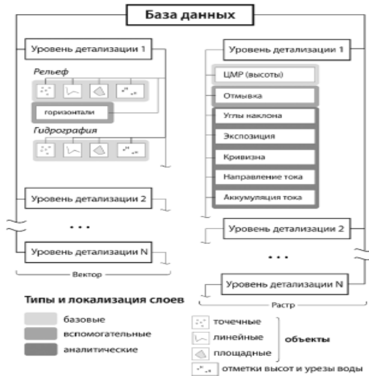
Рис.2.2. Логічна структура бази даних для забезпечення гідрологічного моделювання цифрового рельєфу місцевості.
