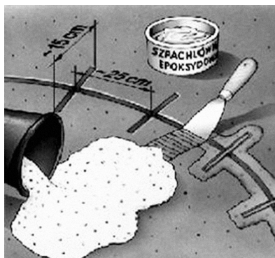
Рис. 3.3.2. Заповнення тріщин матеріалами Ceresit CN 83 + 6% Ceresit CC 83.
