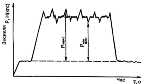
Рис. 2.7.7. Залежність зусилля P від часу випробування.
