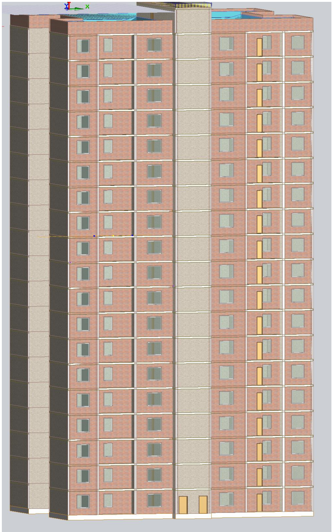
Рис. 1. Розрахункова схема створена в програмному комплексі «САПФІР» Розрахункова схема в подальшому буде доопрацьовуватись в програмному комплексі «ЛІРА-САПР»
