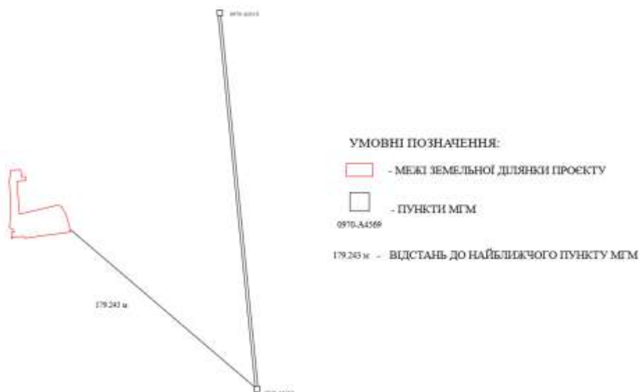
Рис. 2.4. Схема GNSS-спостережень земельної ділянки з пив'язкою до пунктів міської геодезичної мережі (МГМ)
