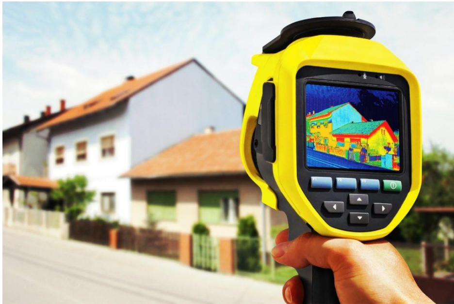
Рис.2. Втрати тепла по контуру будівлі[1]
