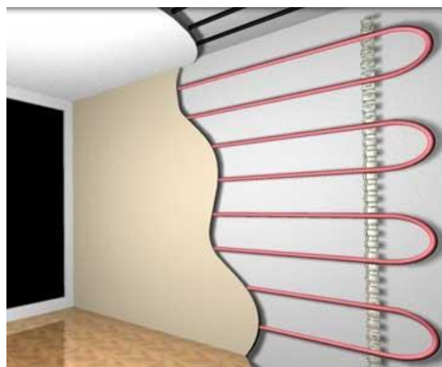
Рис. 6.1. Схема влаштування променистого опалення
