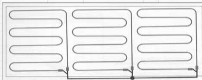
Рис. 4 Три одножильных кабеля, трехфазная система с подключением по схеме типа звезда/треугольник
