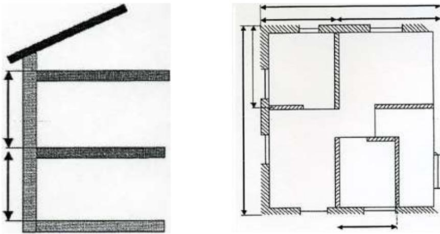
Рис. 1. Приклади визначення розмірів будівельних зовнішніх огорожень
