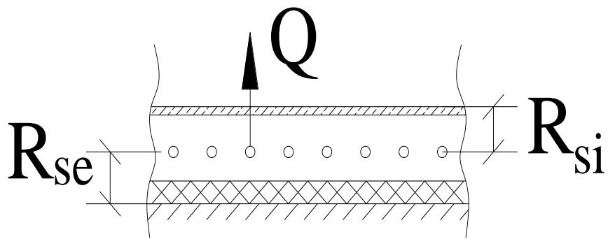
Рис. 5. Опори теплопередачі підлоги
