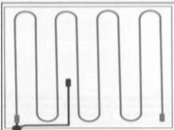
Рис. 5 Расположение датчика
