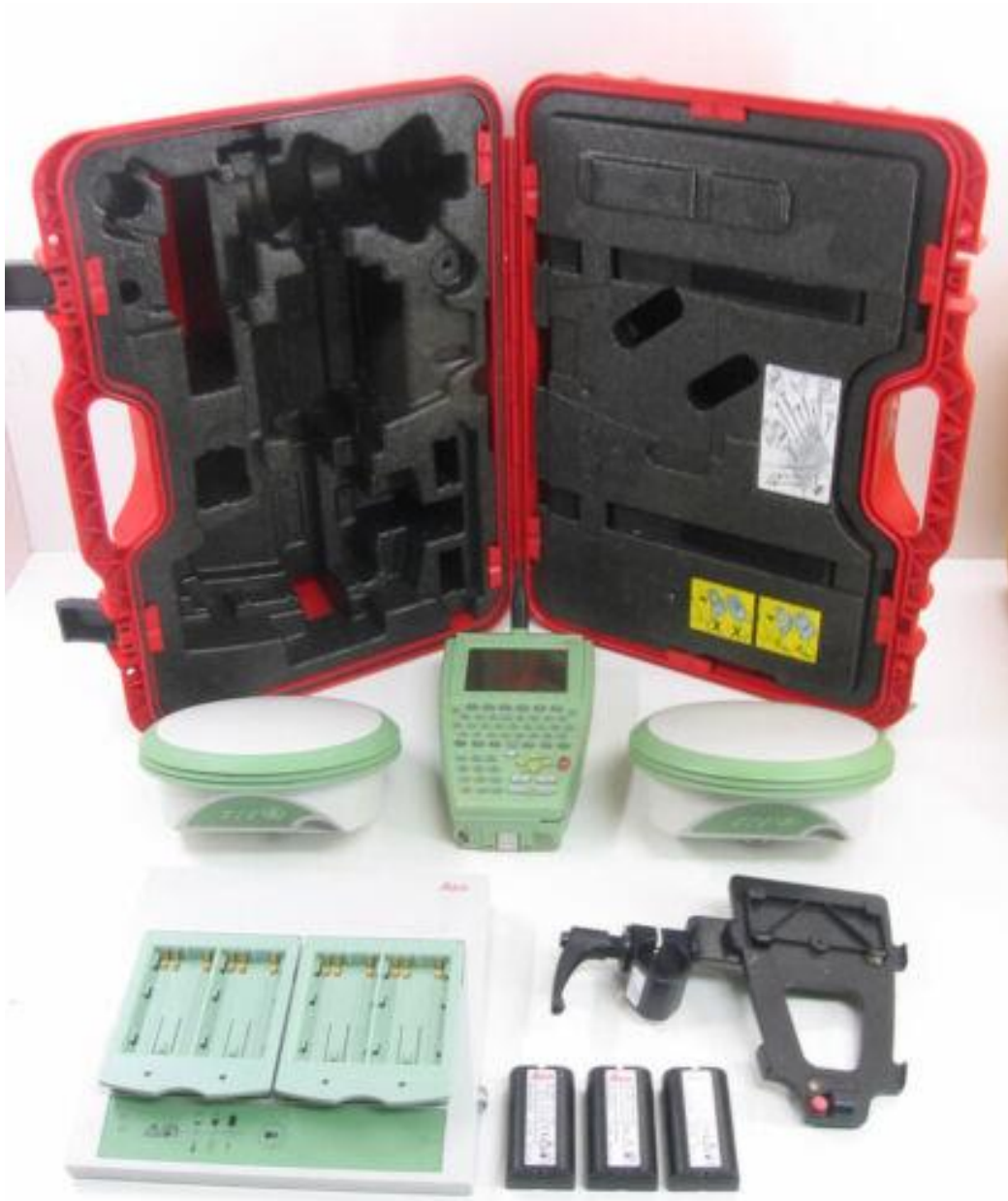
Рис.2.3.1. GPS приймачі Leica Geosystems ATX 1230GG
