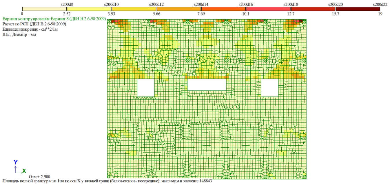
Рисунок 5. Площа арматури на 1м.п по вісі X у нижній грані перекриття 2-го поверху
