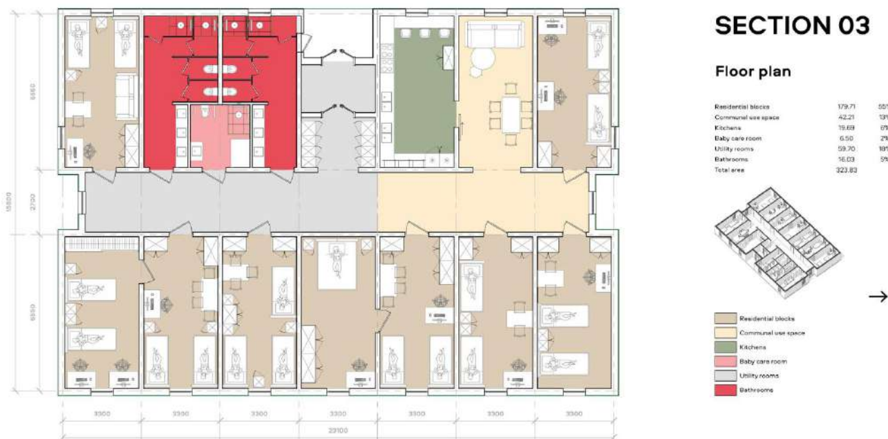
Рис 2.4. Варіант планування однієї з можливих модульних секцій, RE:UKRAINIAN HOUSING, https://www.balbek.com/reukraine-eng
