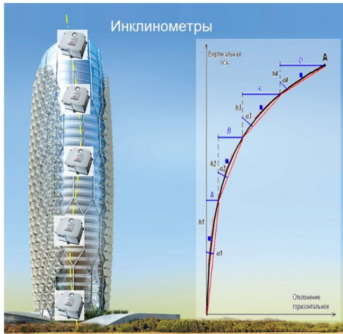
Рис. 5. Вимірювання нахилу і викривлення споруди ланцюжком інклинометрів
