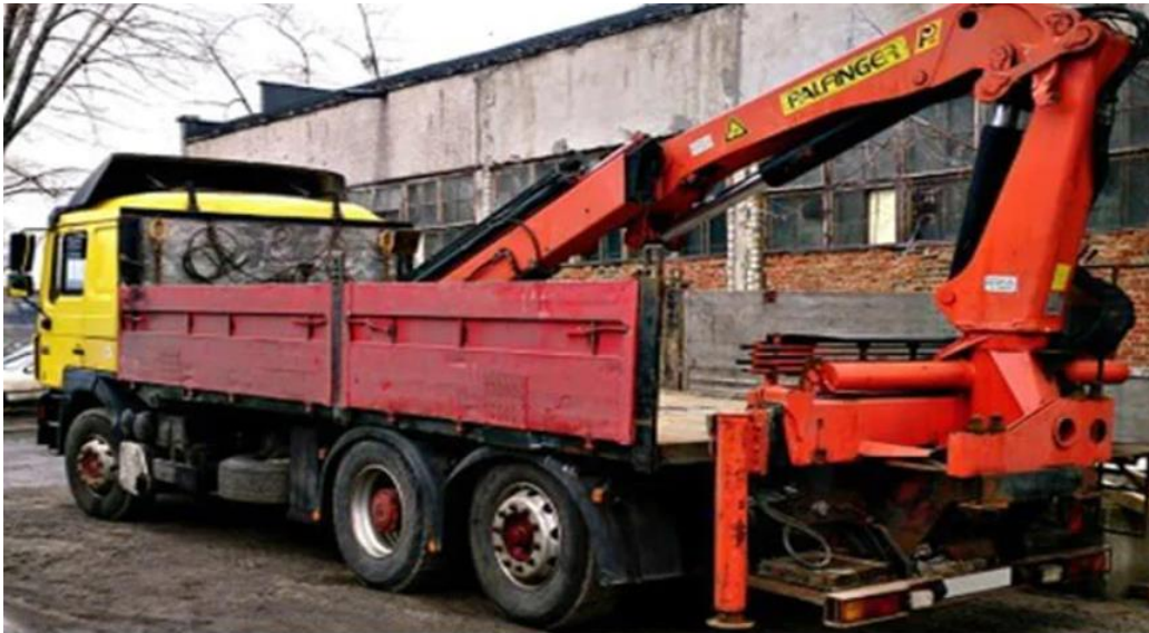
Рисунок 2.2 Автомобіль з системою «кран-маніпулятор» вантажопідйомністю до 26 тонн
