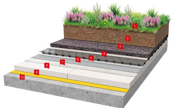
Рис. 6.2.2 Експлуатована покрівля з озелененням [51]
