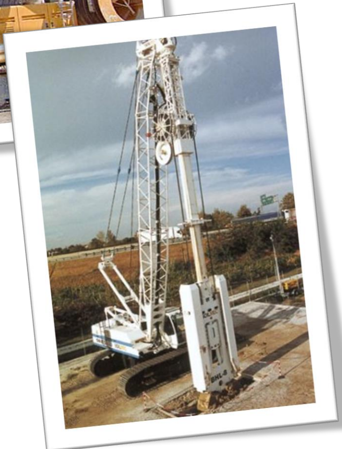
Рис. 29. Бурунабавні і буруін'єкційні механізмами
