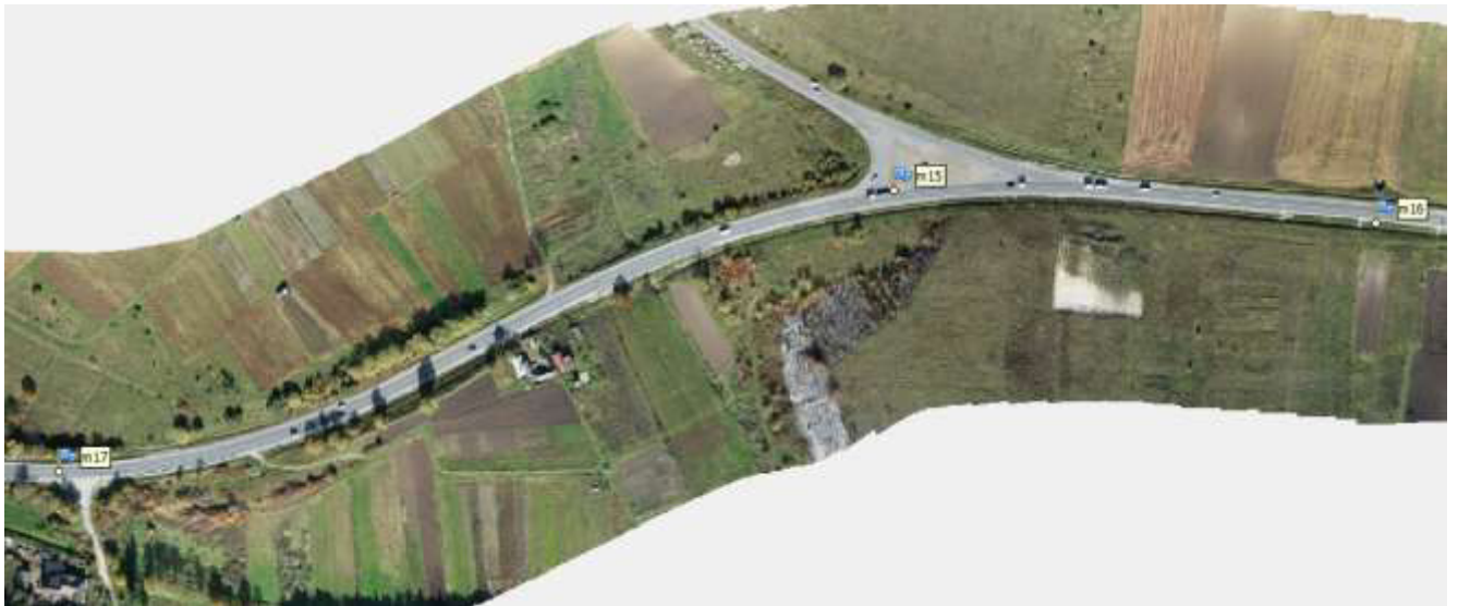
Рис. 3.2. Розташування опорних точок на ділянці виконання робіт
