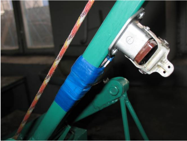
Рис. 3.15. Відтяжка підготовлена до проведення досліджень
