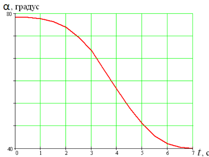
Рис. 4.8. Графік зміни куткової координати стріли в часі:
