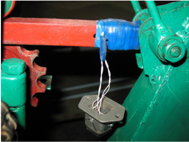
Рис. 3.13. Зубчаста рейка підготовлена до проведення досліджень
