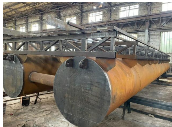
Рис.6.7, рис.6.8 використання металевих понтонів в пірсі та процес виготовлення [68],[69].
