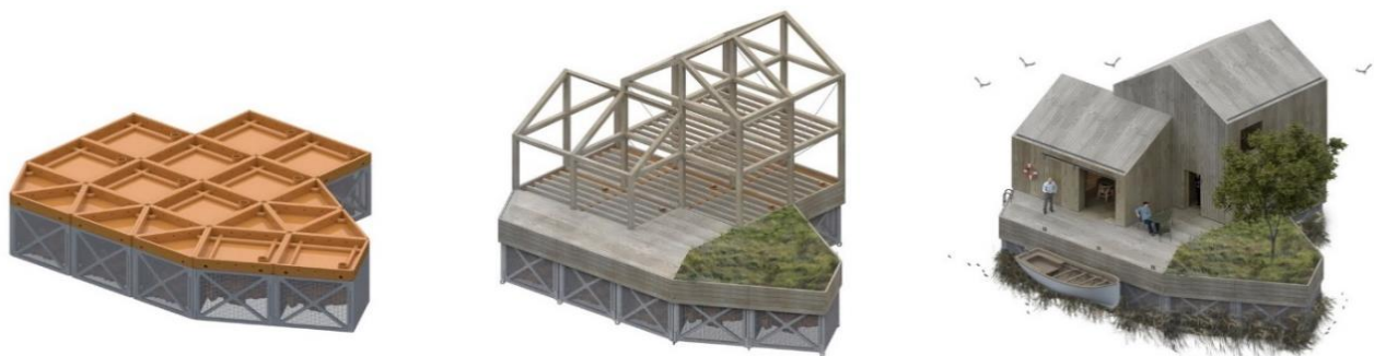
Рис.2.48 Land on Water, MAST, конструктивна схема модулів [47].
