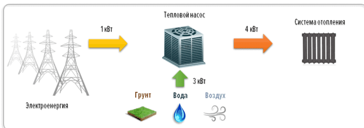
Рис.7.8. Принцип роботи теплового насосу «повітря-вода» [92].
