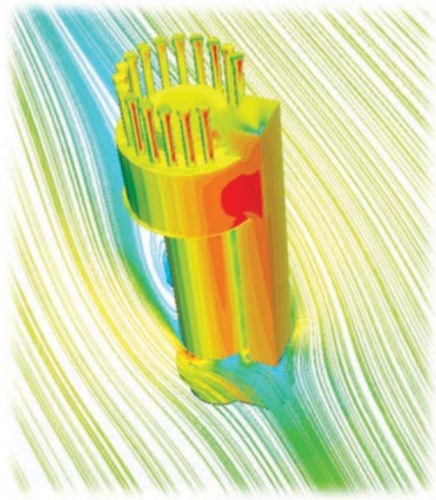
Рис. 1.4. Чисельне моделювання вітрового впливу у програмному комплексі ANSYS
