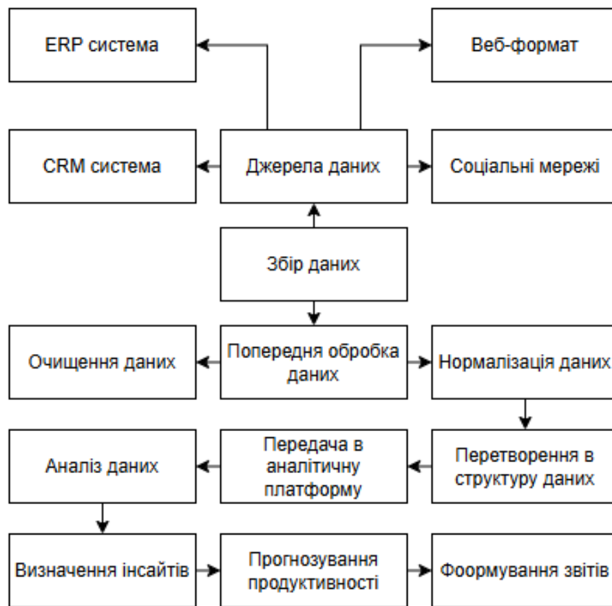
Рисунок 5. Діаграма для збору та обробки даних у комп'ютерній системі
