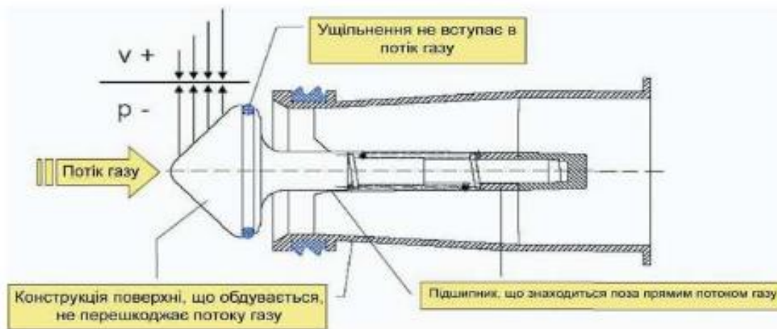
Рис. 4.5. Клапан «Газ-стоп»
