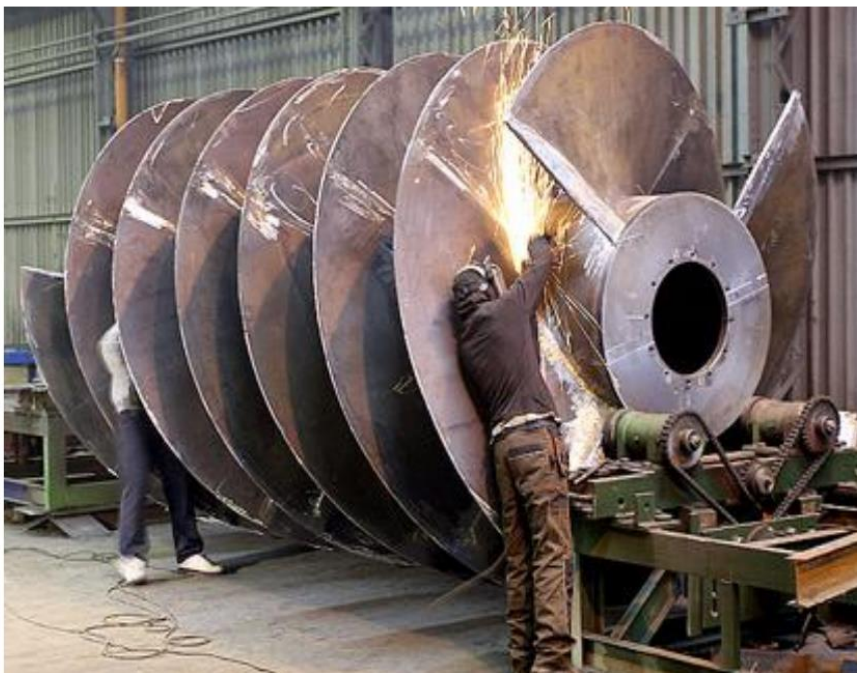
Рис. 3.8. Шнекова гідротурбіна (Archimedes Hydropower)
