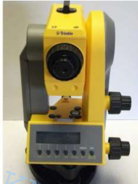
Рис.2 Тахеометр Trimble 3305 DR з безвідбивачевим далекоміром.
