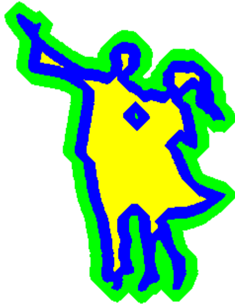
Рис. 7.1. Форма (синім кольором) і його морфологічне розширення (зеленим кольором) і ерозія (жовтим кольором) ромбоподібним структурним елементом
