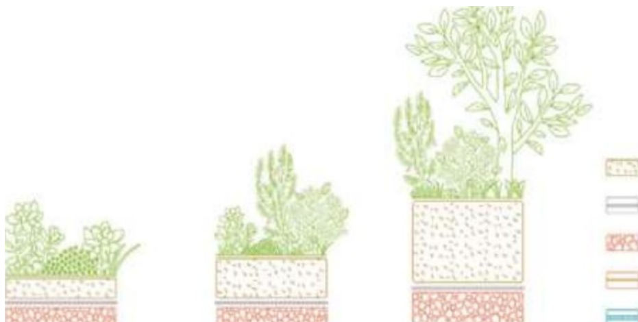
Рисунок 1.1 – Типи і шари конструкції «зеленої» покрівлі
