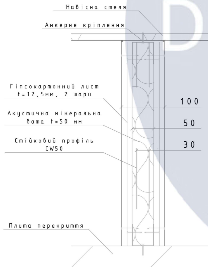
Переріз перегородки між кабінками М 1:5
