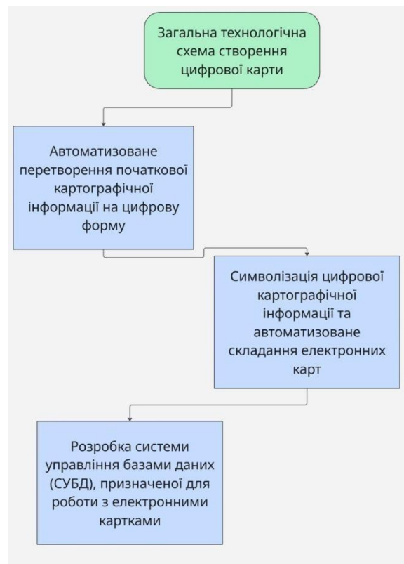
Рис. 2.1 Загальна технологічна схема створення цифрової карти
